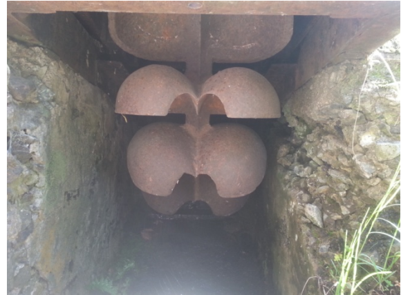
Les augets de la roue dans sa bêche d'origine.
